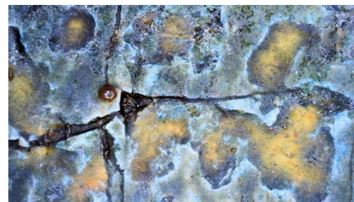
Acció de la calor sobre el blau atzurita. Imatge realitzada amb microscopi digital. Rosa Marina Ruiz, 2022.
