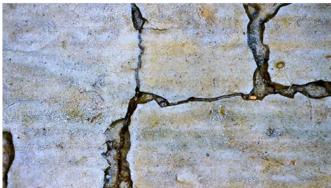
Clivellats profunds on s'entreveu un adhesiu aplicat en una intervenció anterior. Imatge de detall realitzada amb microscopi digital. Rosa Marina Ruiz, 2022.
